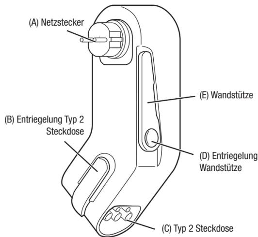
Abb. 1 Produktkomponenten
