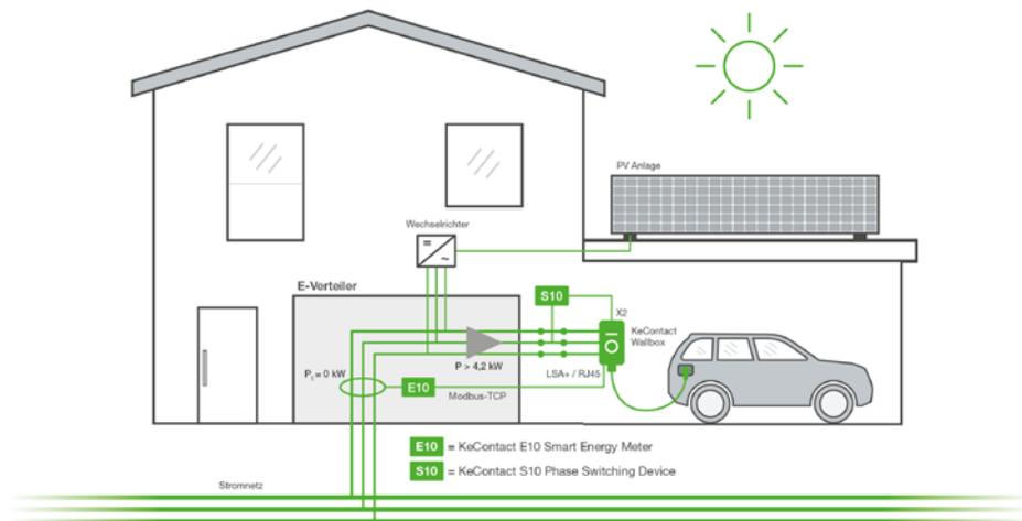
Scheint die Sonne, produziert die PV-Anlage ausreichend Leistung. Der verfügbare Solarstrom für die Wallbox KeContact P30 ist größer als 4,2 kW – somit sind alle 3 Phasen via KeContact S10 zur Wallbox durchgeschaltet. Abhängig vom Fahrzeug kann eine Solar-Überschussleistung von bis zu 22 kW in das Elektrofahrzeug geladen werden.
