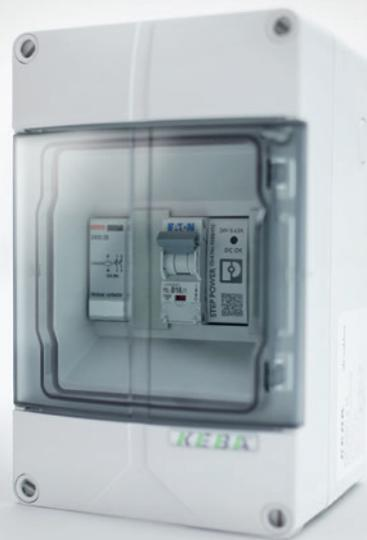
KeContact S10 Phase Switching Device ist die ideale Ergänzung zur KeContact PV EDITION-Wallbox für optimiertes PV-Überschussladen: Der Phasenumschalter KeContact S10 schaltet, je nach momentan verfügbarer Leistung der Photovoltaik-Anlage, automatisch zwischen ein- und dreiphasigem Laden um. Das maximiert die Eigennutzung des selbst produzierten Photovoltaik-Stroms - auch bei z.B. wetterbedingt geringerer Photovoltaik-Leistung.
