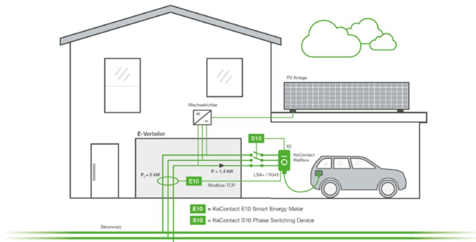
Sobald Wolken aufziehen, ist die Solarleistung zur Wallbox in Summe kleiner als 4,2 kW\*. Der verbleibende Überschuss wird dann, solange vorhanden, nicht mehr zum Laden verwendet, sondern ins Netz zurück gespeist. Ist kein Überschuss mehr vorhanden, wird wieder Strom aus dem Netz bezogen. Mit dem optionalen Phasenumschalter KeContact S10 Phase Switching Device von KEBA kann die 4,2 kW\* Schwelle auf 1,4 kW\* gesenkt werden!
